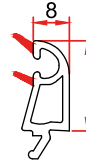
Mamül Kodu/Product Code/Код изделия: 6039 Kanat 42mm Cam Çıtası Sash 42mm Glazing Bead Штапик створки 42мм
