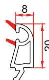
Mamül Kodu/Product Code/Код изделия: 6039 32 mm Cam Çıtası 32 mm Glazing Bead Штапик 32мм
